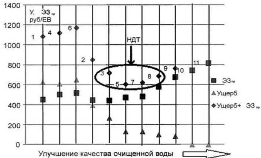
Рисунок 7 - Зависимость качества очищенных стоков от отношения предотвращенного ущерба и \mathcal{E}Z_{\text{пр}} очистных сооружений производительностью 32-40 тыс. м 3 /сут при использовании НДТ
