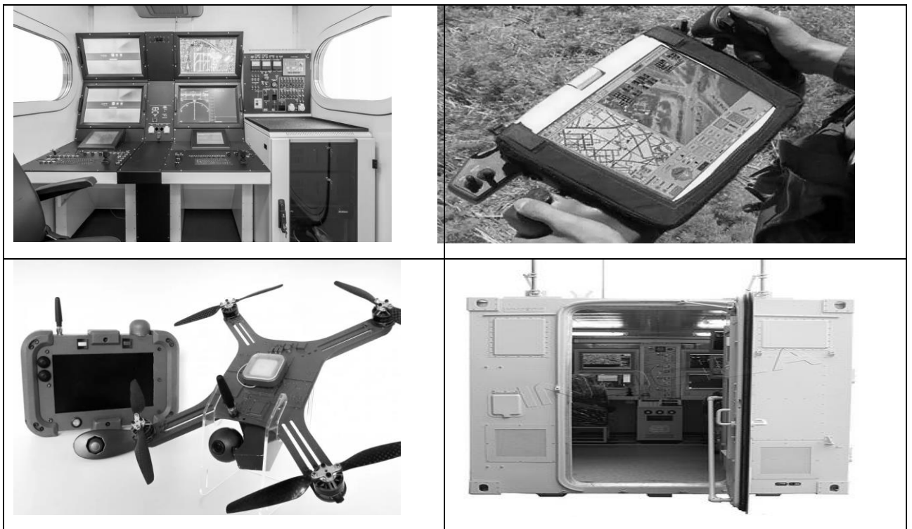
Рисунок 1.1.1 – Примеры различных вариантов реализации наземной подсистемы дистанционного управления БАК
