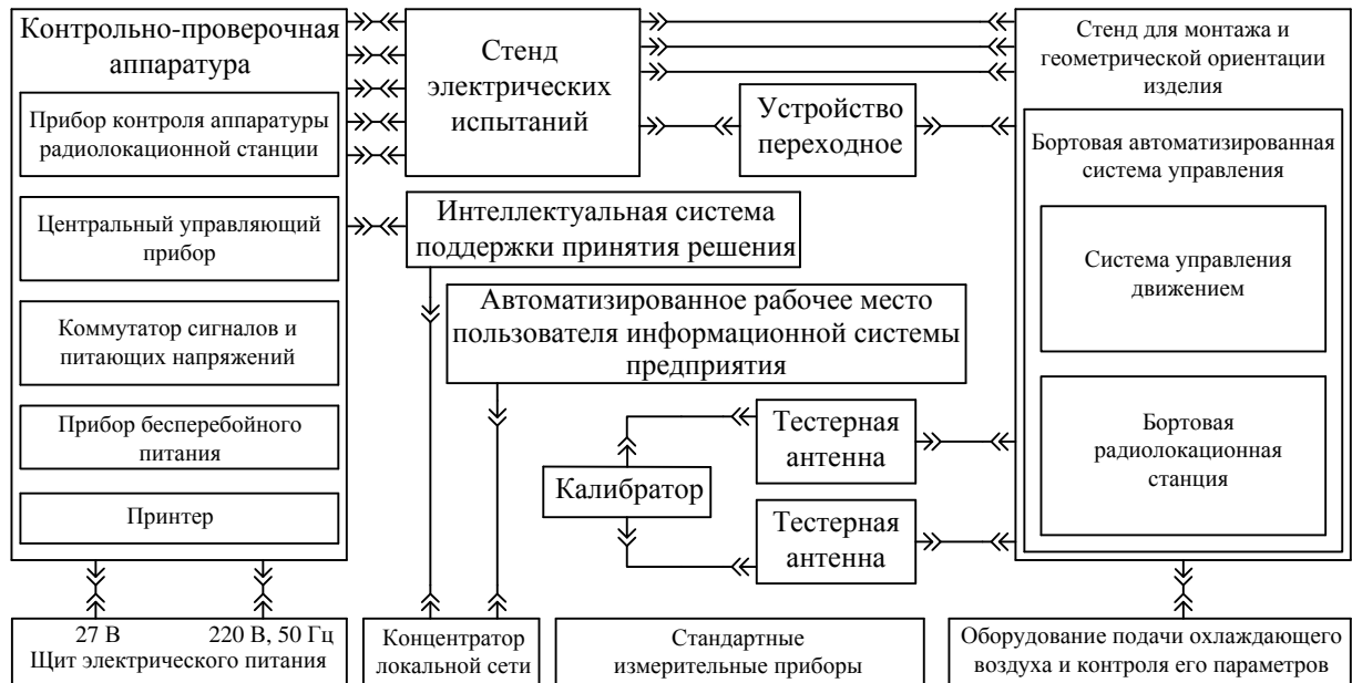
Рисунок 2.8 - Схема рабочего места проверки изделия
