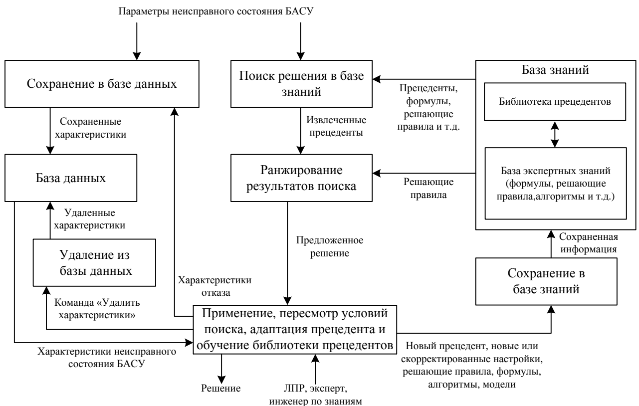
Рисунок 3.13 - Модель процесса диагностирования БАСУ
