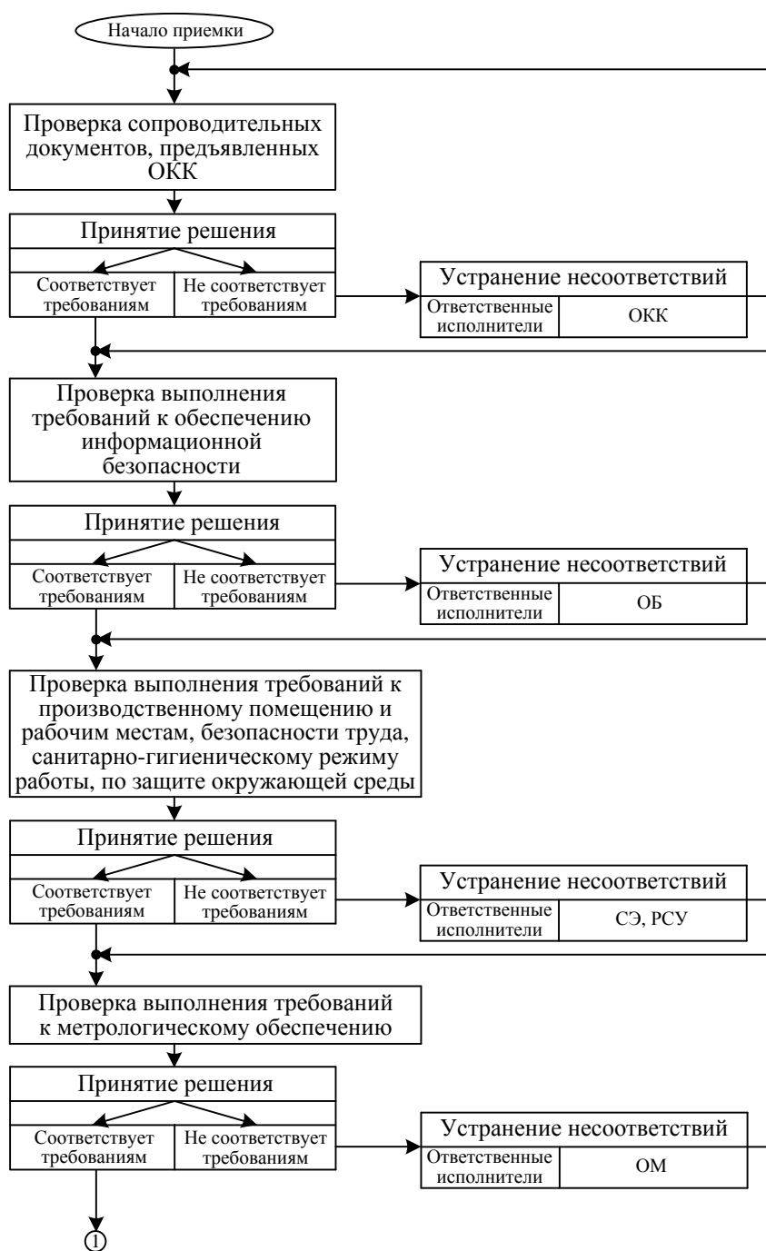
Рисунок Е.1 - Блок-схема алгоритма проведения приемочного контроля БАСУ
