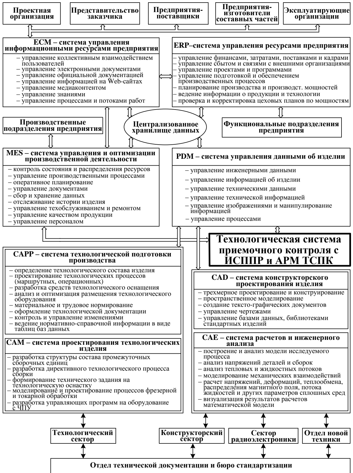
Рисунок 2.10 - Структурная схема организации ЕИП предприятия
