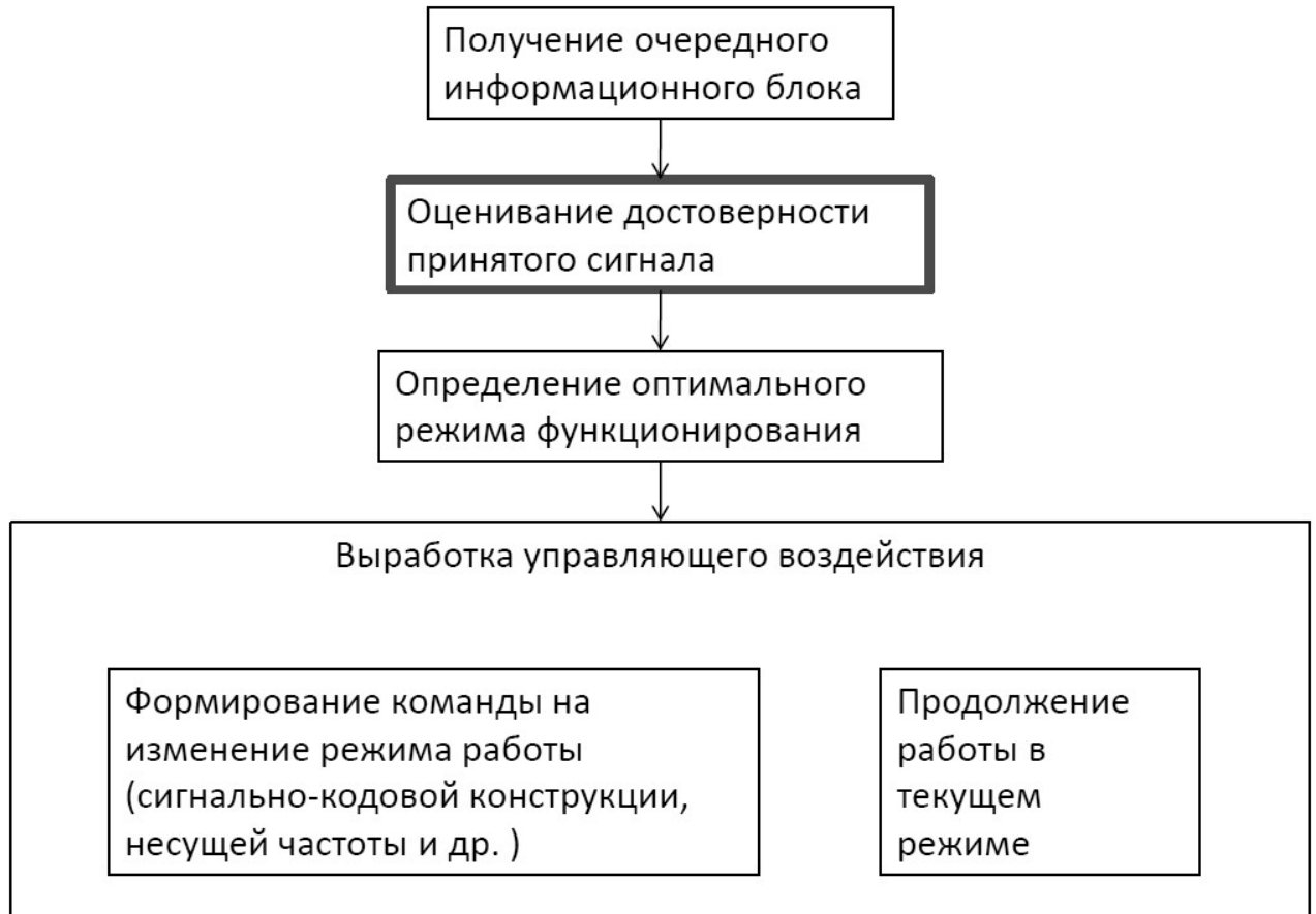
Рисунок 1.3 – Процесс адаптивного управления радиолинией
