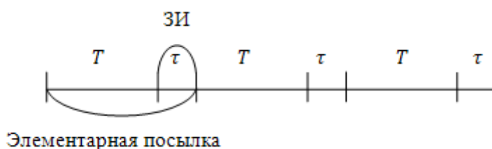
Рисунок 2.20 – Условное изображение трех элементарных посылок OFDM сигнала с защитным интервалом
