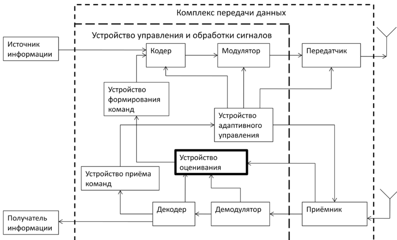
Рисунок 1.2 – Упрощенная структурная схема адаптивного комплекса передачи данных
