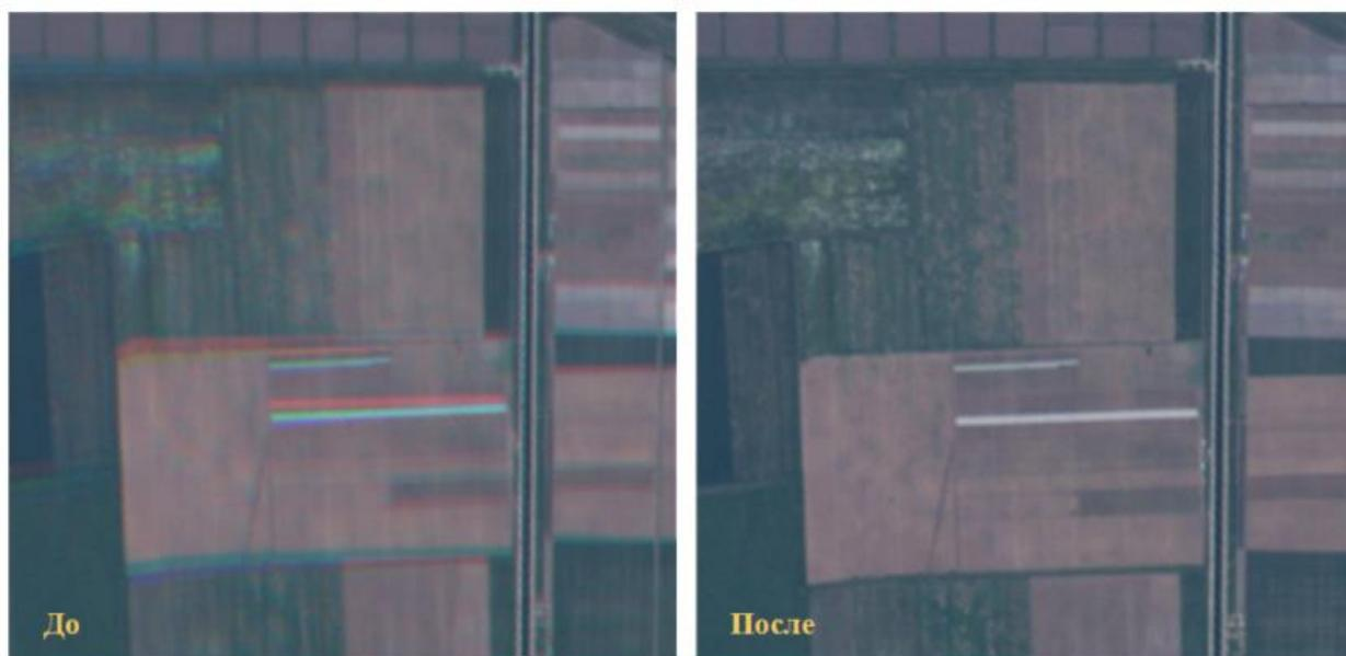
Рисунок 1.11 – Уточнение географической привязки по опорным точкам [100]
