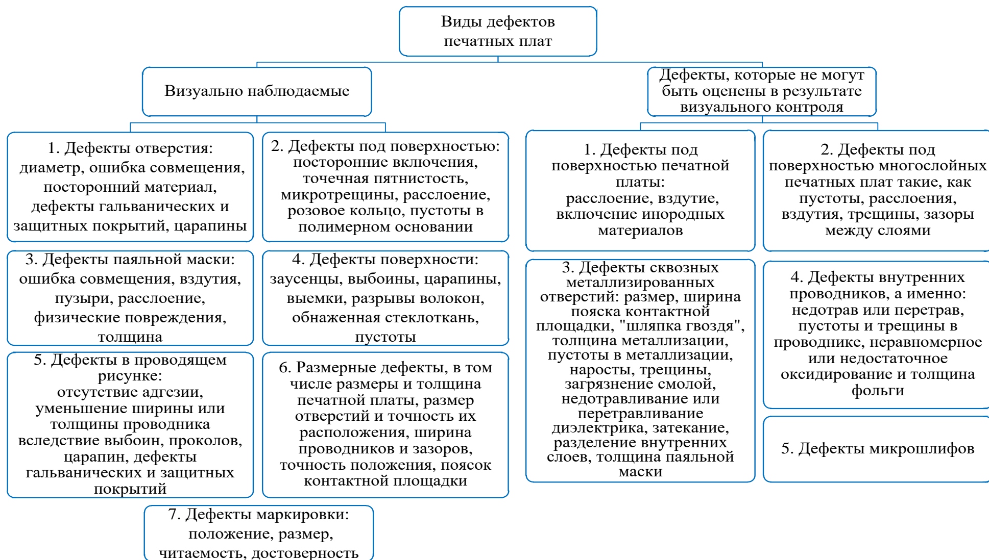
Рисунок 24 – Виды дефектов печатных плат в соответствии ГОСТ Р 56251-2014 «Платы печатные. Классификация дефектов»
