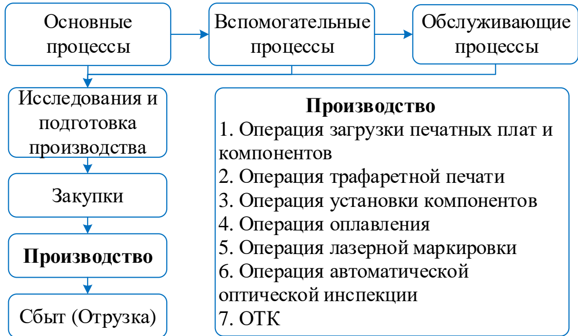
Рисунок 38 – Процессный подход производственного цикла изготовления радиоэлектроники
