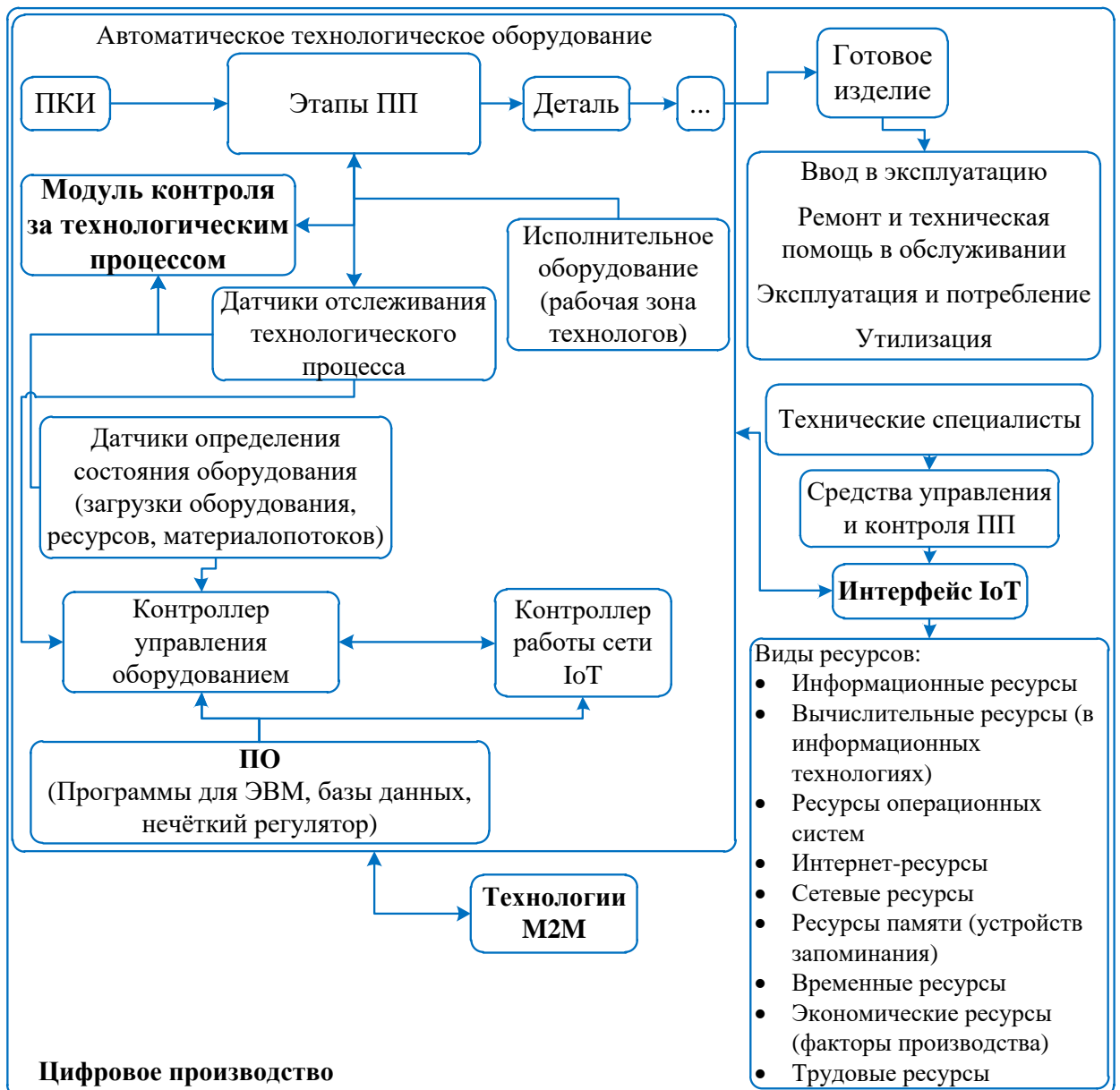
Рисунок 54 – Взаимодействие автоматического технологического оборудования, киберфизических систем и специалистов на цифровом производстве
