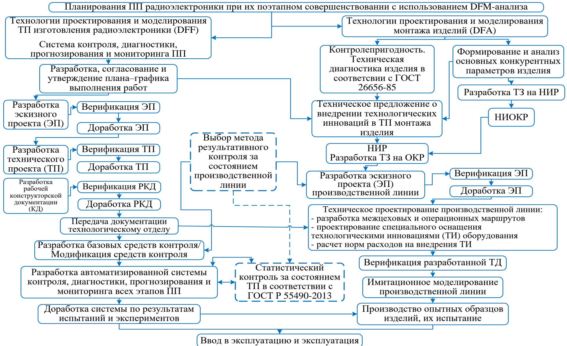
Рисунок 49 – Структурная схема разделения ПП на DFF и DFA с адаптивной конфигурацией производственной линии в зависимости от вида изделия
