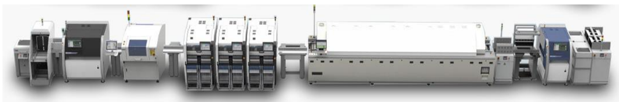
Рисунок 22 – Производственная линия монтажа радиоэлектронных изделий
