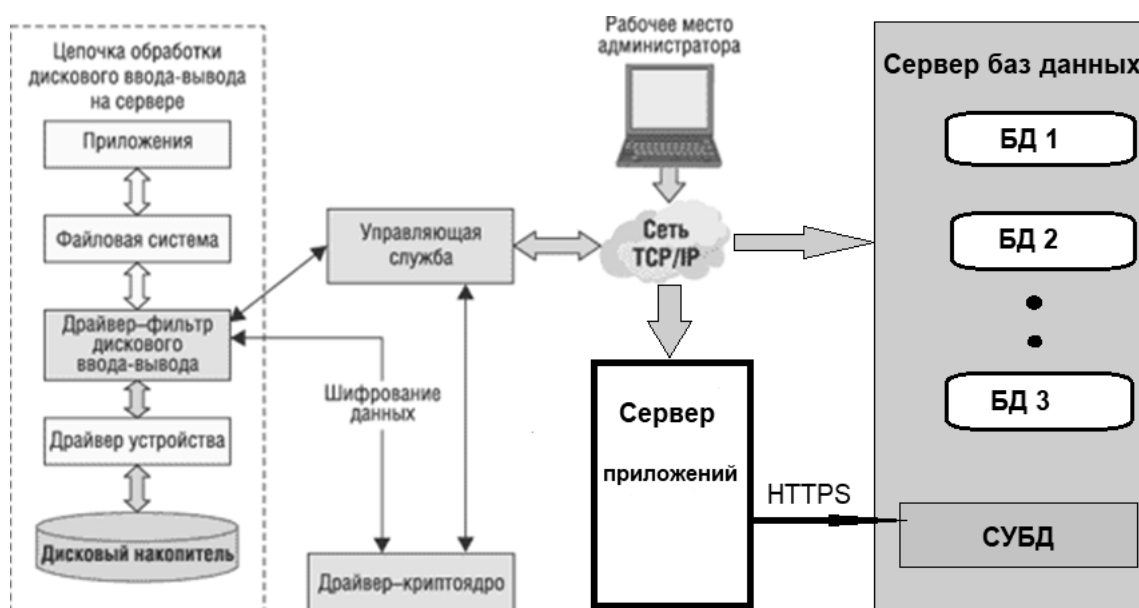
Рисунок 1.2.3 – Пример программной архитектуры ПАК Data-центра
