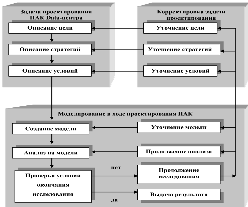
Рисунок 2.2.3 – Схема процесса корректуры задачи проектирования ПАК Data-центра, определяемой группой требований к назначению
