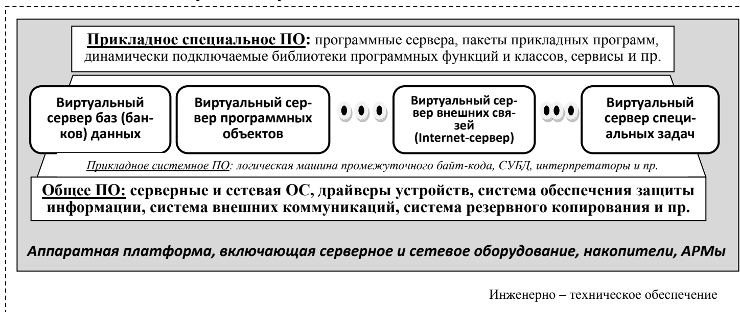
Рисунок 1.2.1 – Обобщенное представление программно-технической структуры ПАК для Data-центров в виде схемы вложенности
