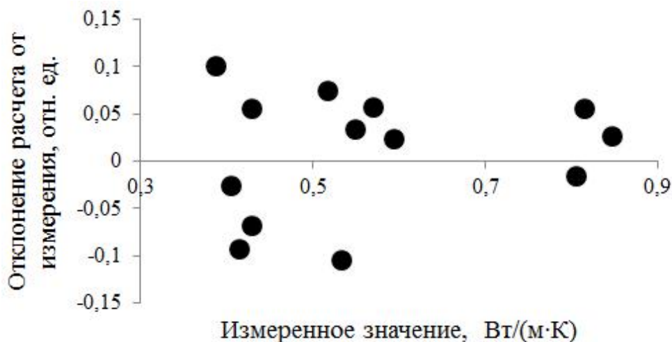
Рисунок 2.19 – Сравнение расчётных и измеренных значений теплопроводности образцов [105]
