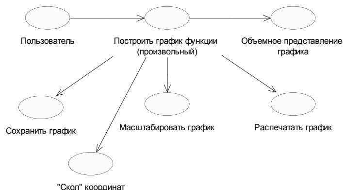
Рисунок 5.1.3 – UML-диаграмма вариантов использования «Просмотреть график функции (произвольной)»
