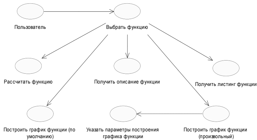
Рисунок 5.1.2 – UML-диаграмма вариантов использования библиотеки функций
