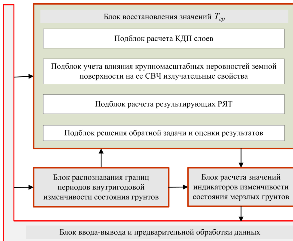
Рисунок 27 – Обобщенная структура алгоритма оценки изменчивости состояния мерзлых грунтов по данным спутниковой СВЧ радиометрии
