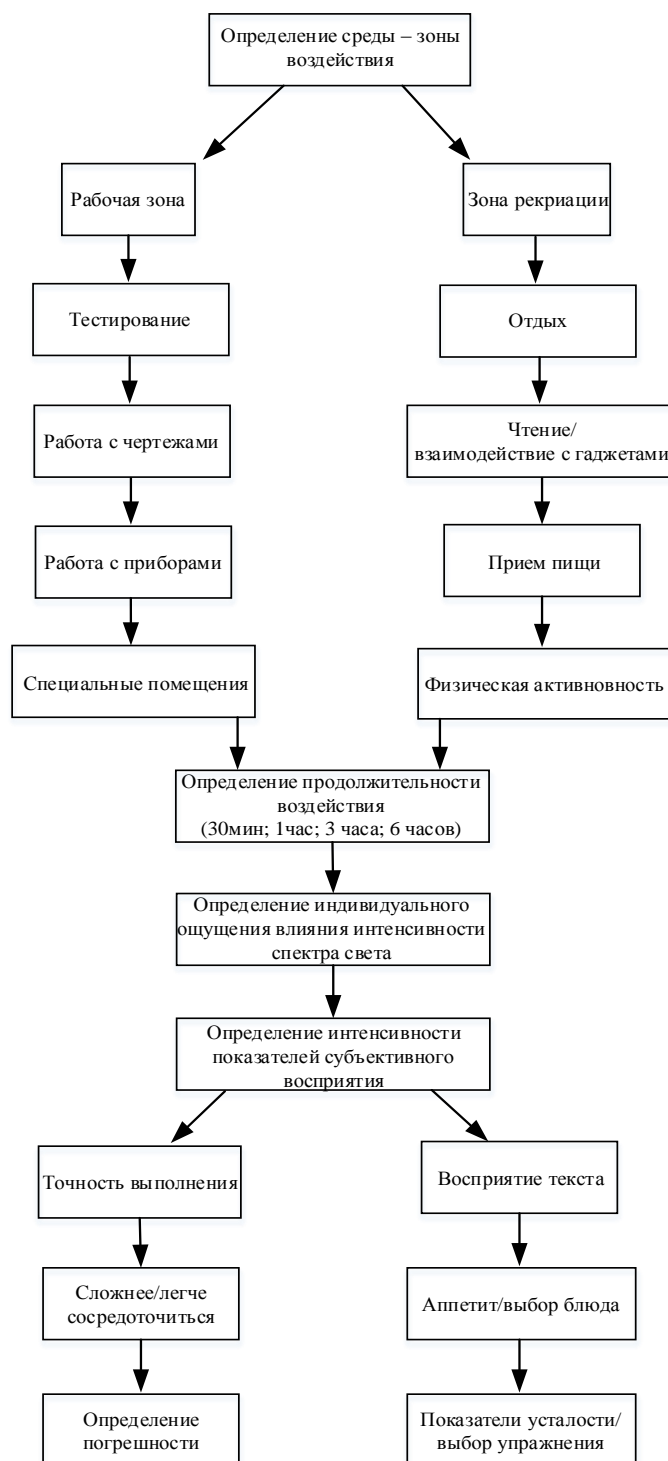
Рисунок 4.9 – Структурная схема методики контроля и оценки рабочих и психофизических показателей воздействия светодиодного освещения
