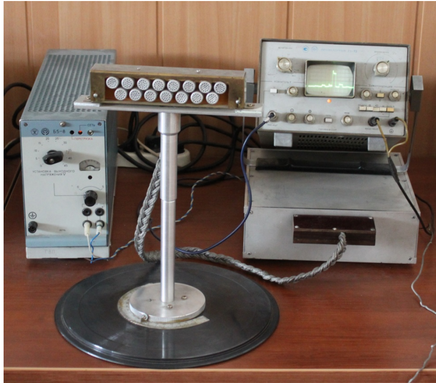
Рисунок 2.17 – Вид лабораторной установки для определения характеристик АЭУ пространственной обработки сигналов линейной АР
