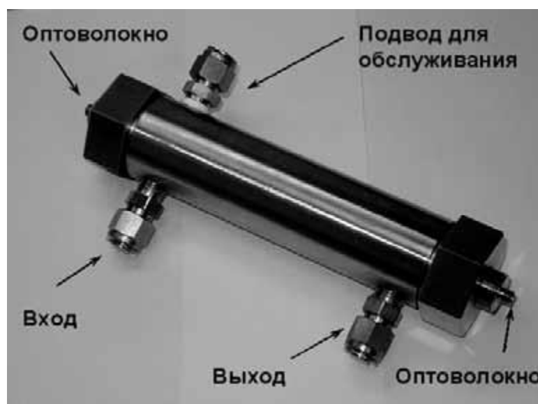
Рисунок 7 – Конструкция модуля для измерения спектра поглощения углеводородами с применением ВОСП
