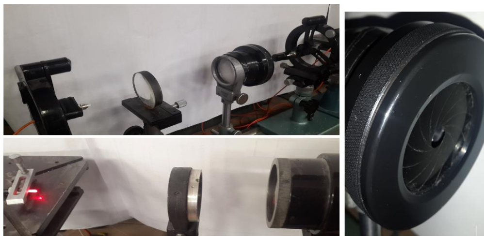
Рисунок 39 – Экспериментальная установка для определения энергетических потерь
