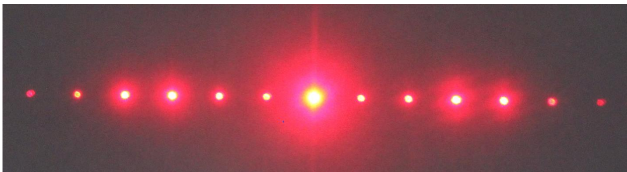
Рисунок 46 – Дифракционная картина от высокопорядковой решетки
