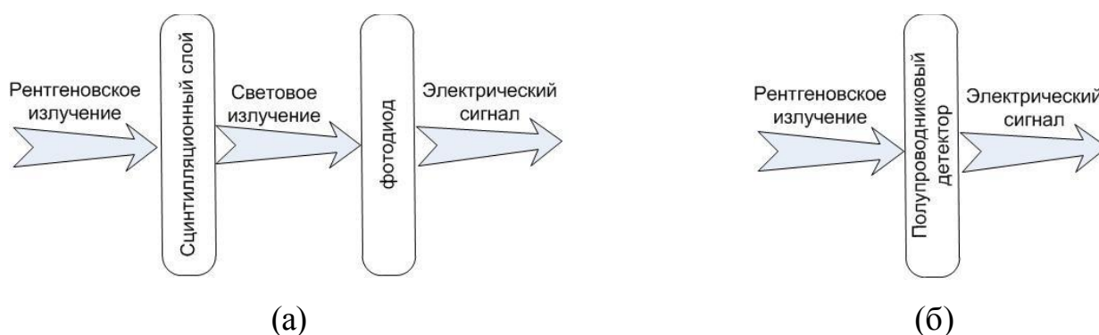
Рисунок 1.7 - Схема преобразования информации в детекторах со сцинтилляционным слоем (а) и без него (б)
