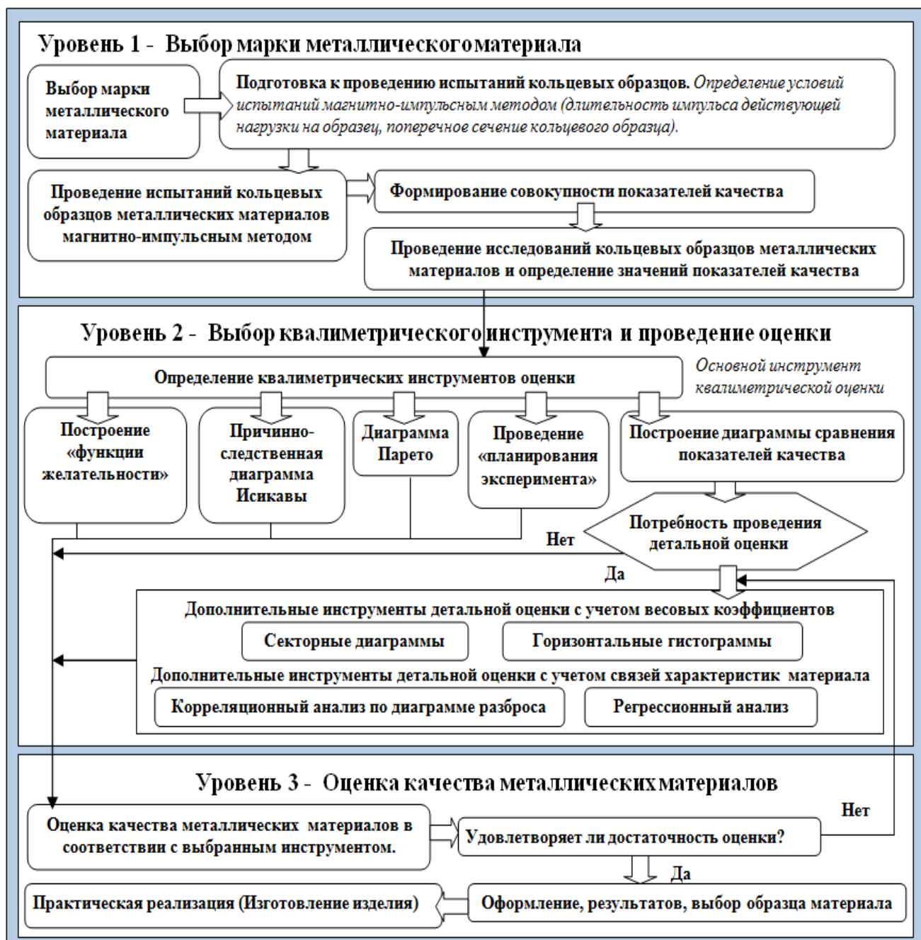
Рисунок 19 – Методика проведения оценки качества металлических материалов, испытанных магнитно-импульсным методом
