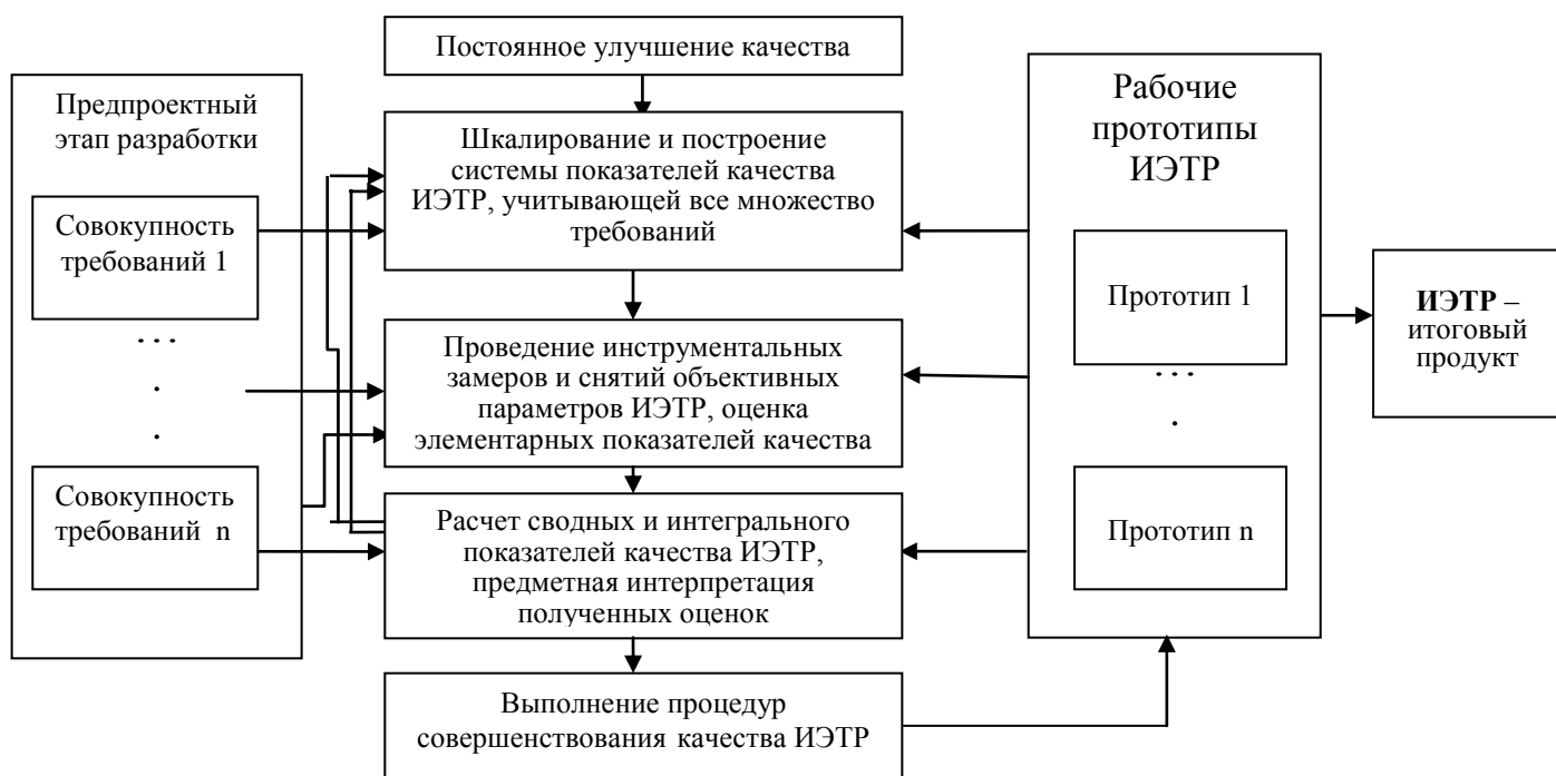
Рисунок 1.1.7 – Обобщенная схема системы качества ИЭТР при его разработке
