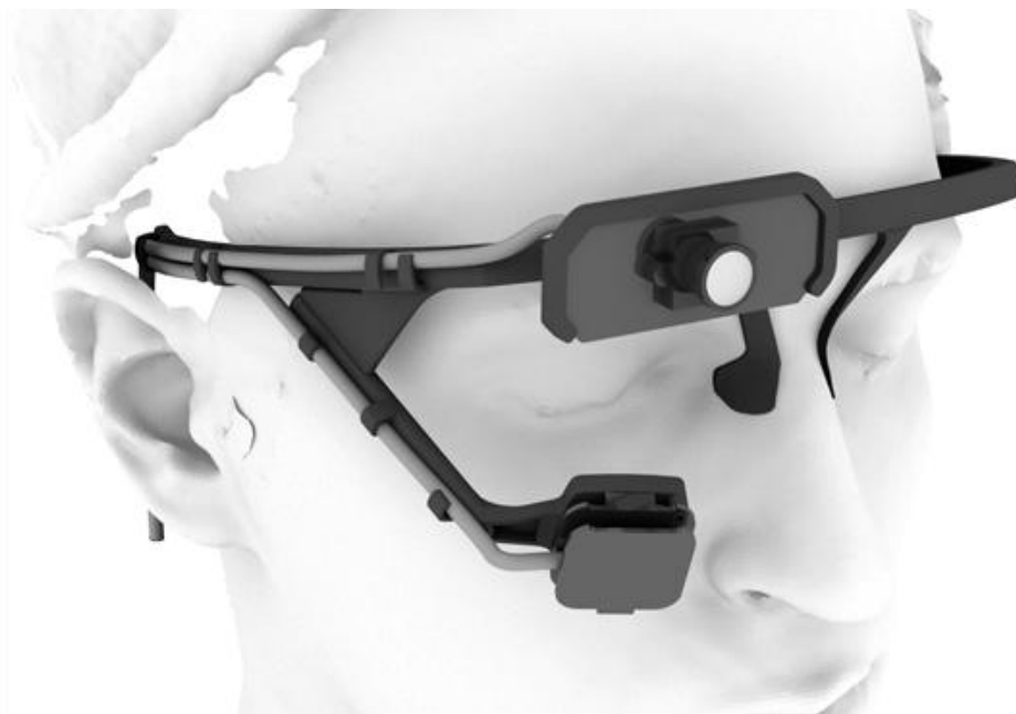
Рисунок 3.3.1. – Применение ай-трекера как периферийного устройства для управления работой ИЭТР при проведении мероприятий технического обслуживания авиационной техники
