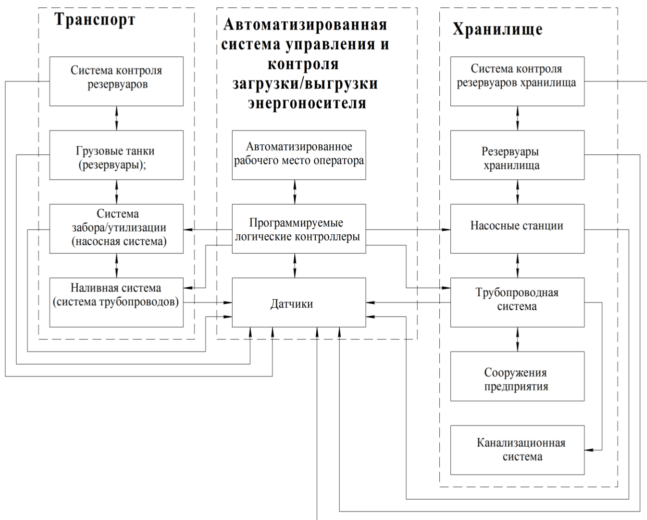
Рисунок 2.1 – Структура автоматизированного управления производственно-технической системой загрузки/выгрузки энергоносителя.
