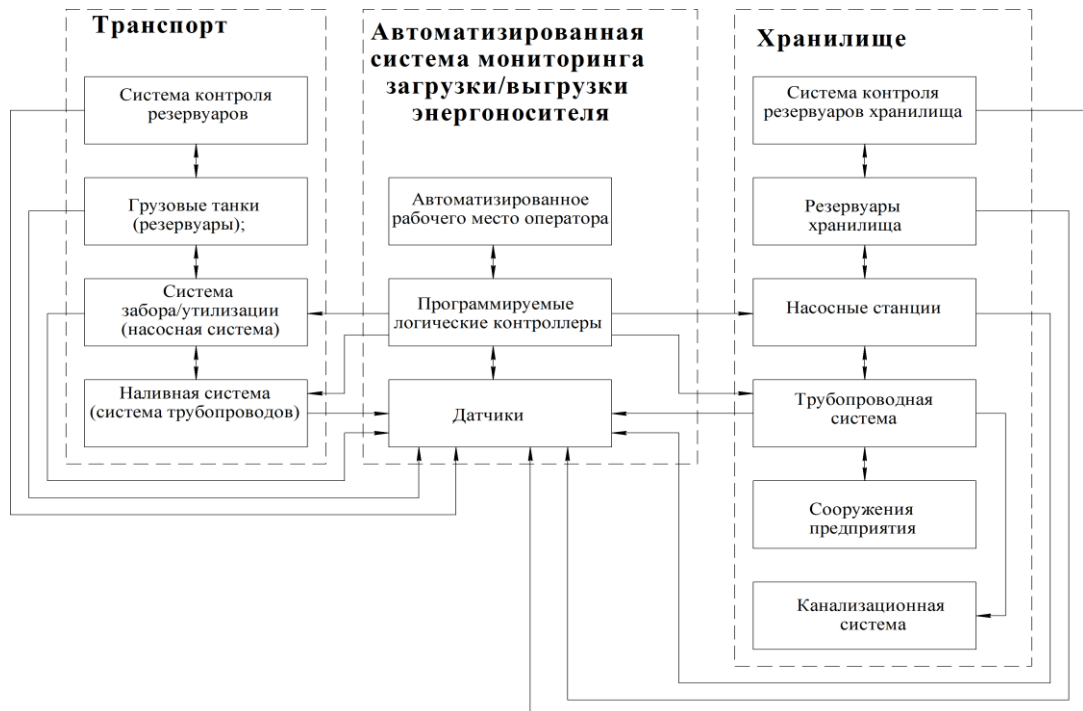
Рисунок 1 – Структура производственно-технической системы загрузки/выгрузки энергоносителя
