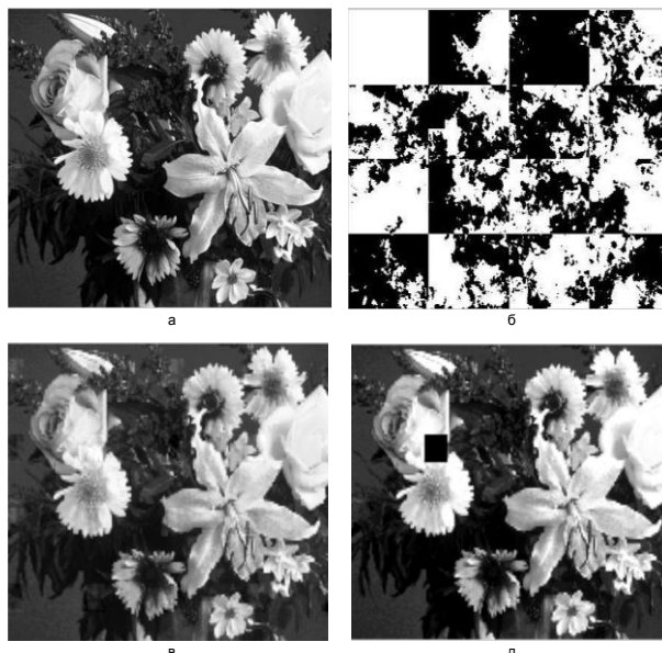
Рисунок 2.7 – Двухстороннее стрип-преобразование (а – исходное изображение, б – преобразованное изображение, в – восстановленное изображение с использованием стрип-преобразования, д – изображение после передачи в канале с помехой без использования стрип-преобразования)
