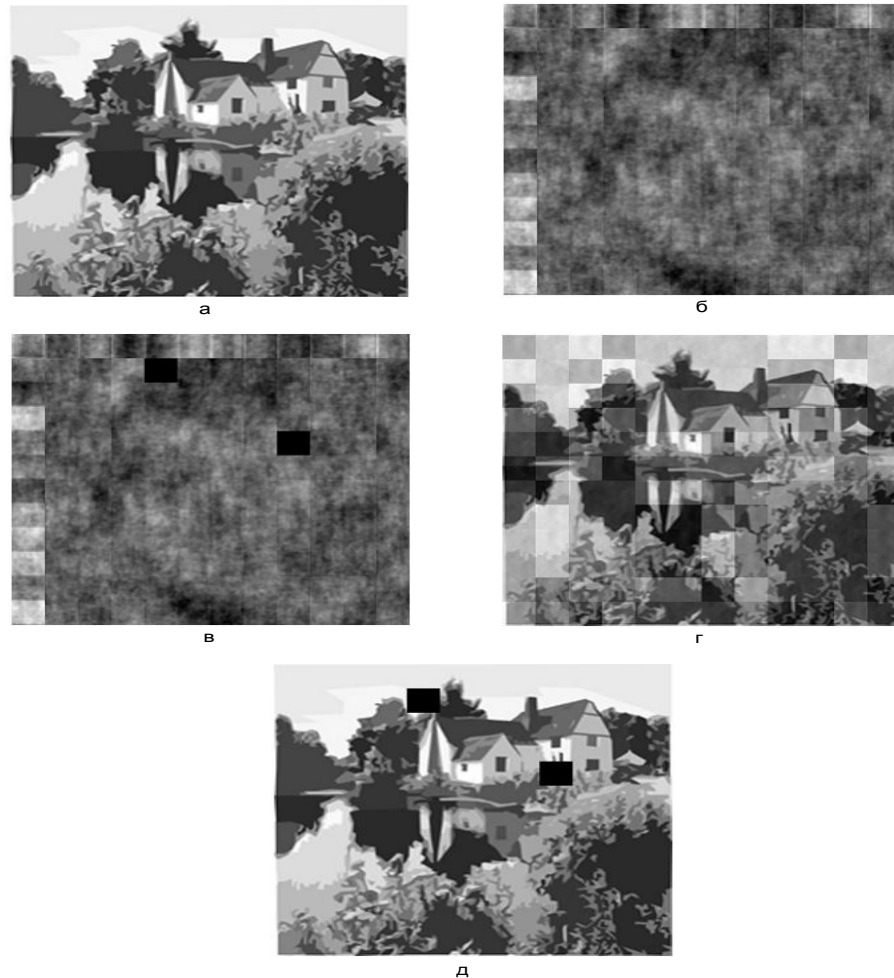
Рисунок 2.8 – Двухстороннее стрип-преобразование (а – исходное изображение, б – преобразованное изображение, в – преобразованное изображение с внесенной помехой, г – восстановленное изображение с использованием стрип-преобразования, д – изображение после передачи в канале с помехой без стрип-преобразования)
