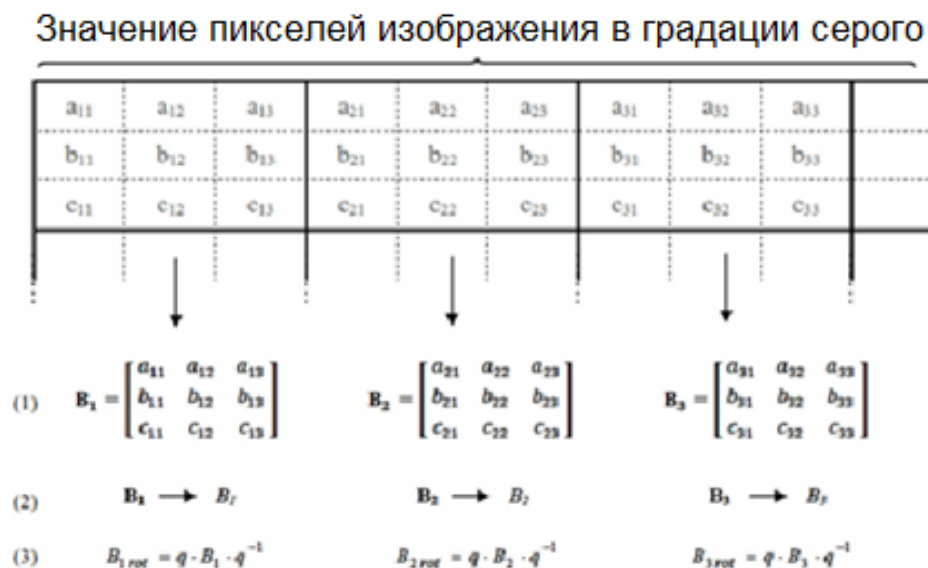
Рисунок 2.3 – Реализация метода поблочного маскирования изображения в градации серого с использованием кватернионов
