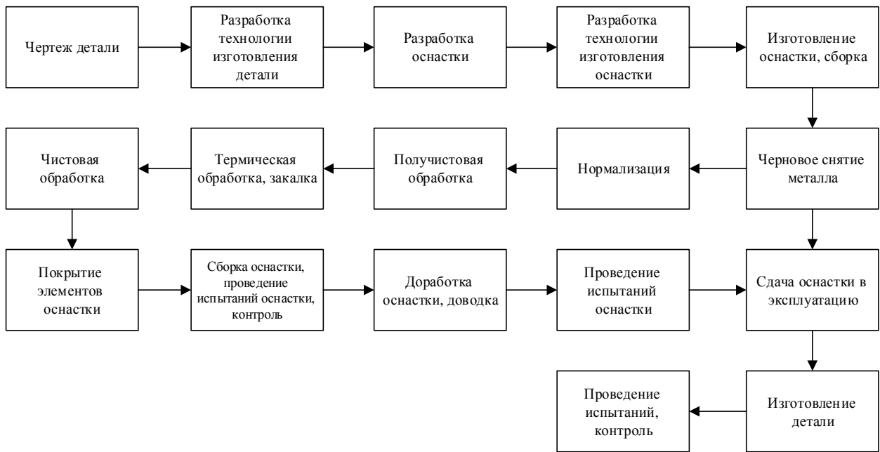
Рисунок 1.5 – Традиционная технология изготовления корпуса РЭА
