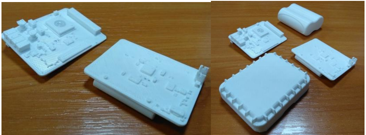
Рисунок 1.34 – Готовый корпус РЭА и прототипированная компонентная база РЭА
