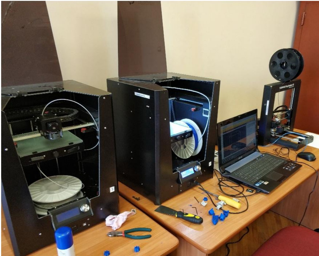
Рисунок 1.44 – Типы аддитивных установок, использующие 3 степени свободы.
