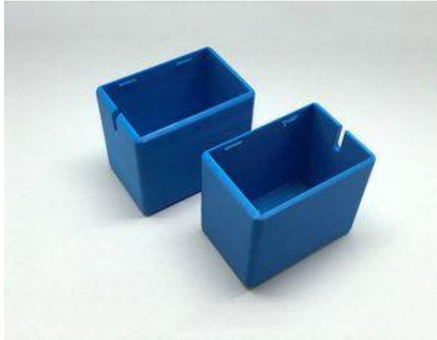
Рисунок 2.5 – Корпус РЭА, произведённый при помощи технологии МПН
