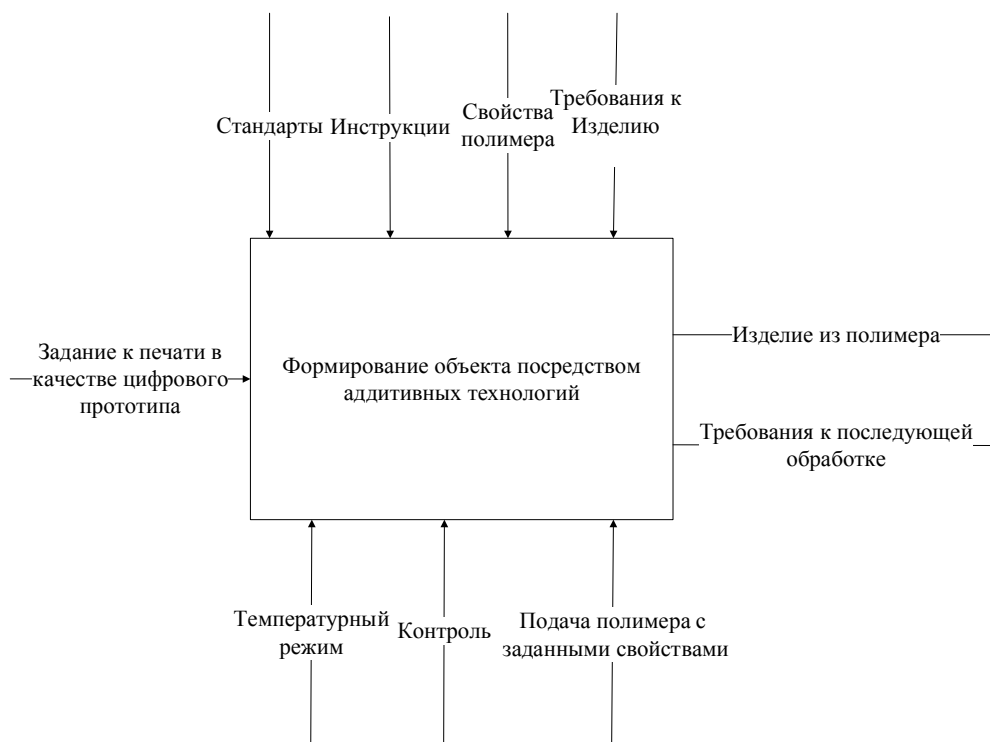
Рисунок 1.25 – Диаграмма процесса создания корпуса РЭА на основе аддитивных технологий
