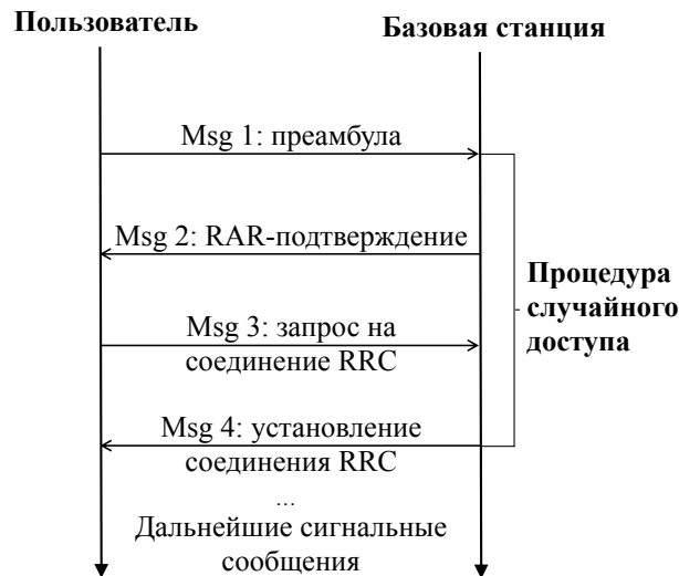
Рисунок 4.3 — Порядок процедуры случайного доступа в системе LTE
