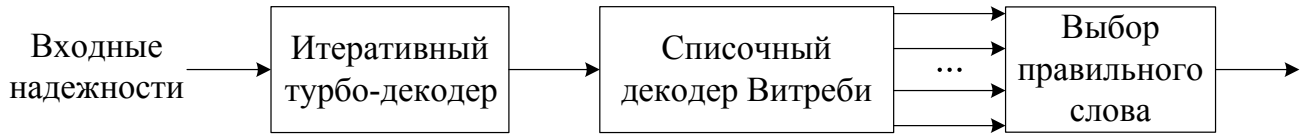
Рисунок 2.2 – Списочное декодирование турбокода с использованием списочного декодера Витерби
