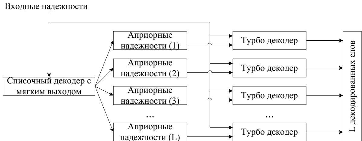
Рисунок 2.6 – Схема предложенного списочного декодера турбокода
