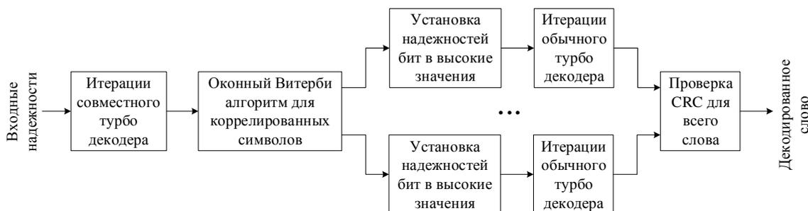
Рисунок 10 – Схема совместного турбо-декодера №2
