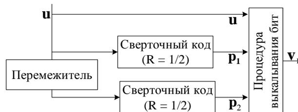
Рисунок 1 – Схема кодера турбокода
