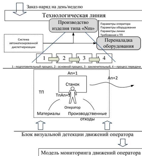
б – Схема развертывания оптического стенда для мониторинга движений оператора
