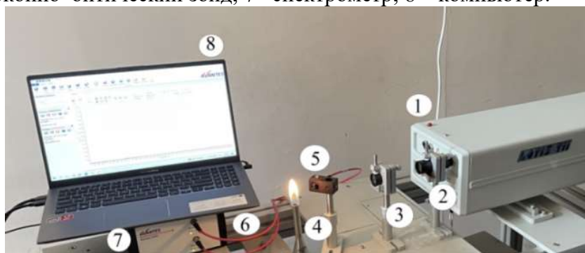
Рисунок 13 – Экспериментальный стенд с ЛИЭС-установкой
