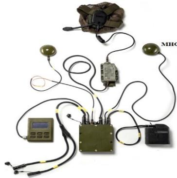
Рисунок 7 - Модуль навигационной системы
