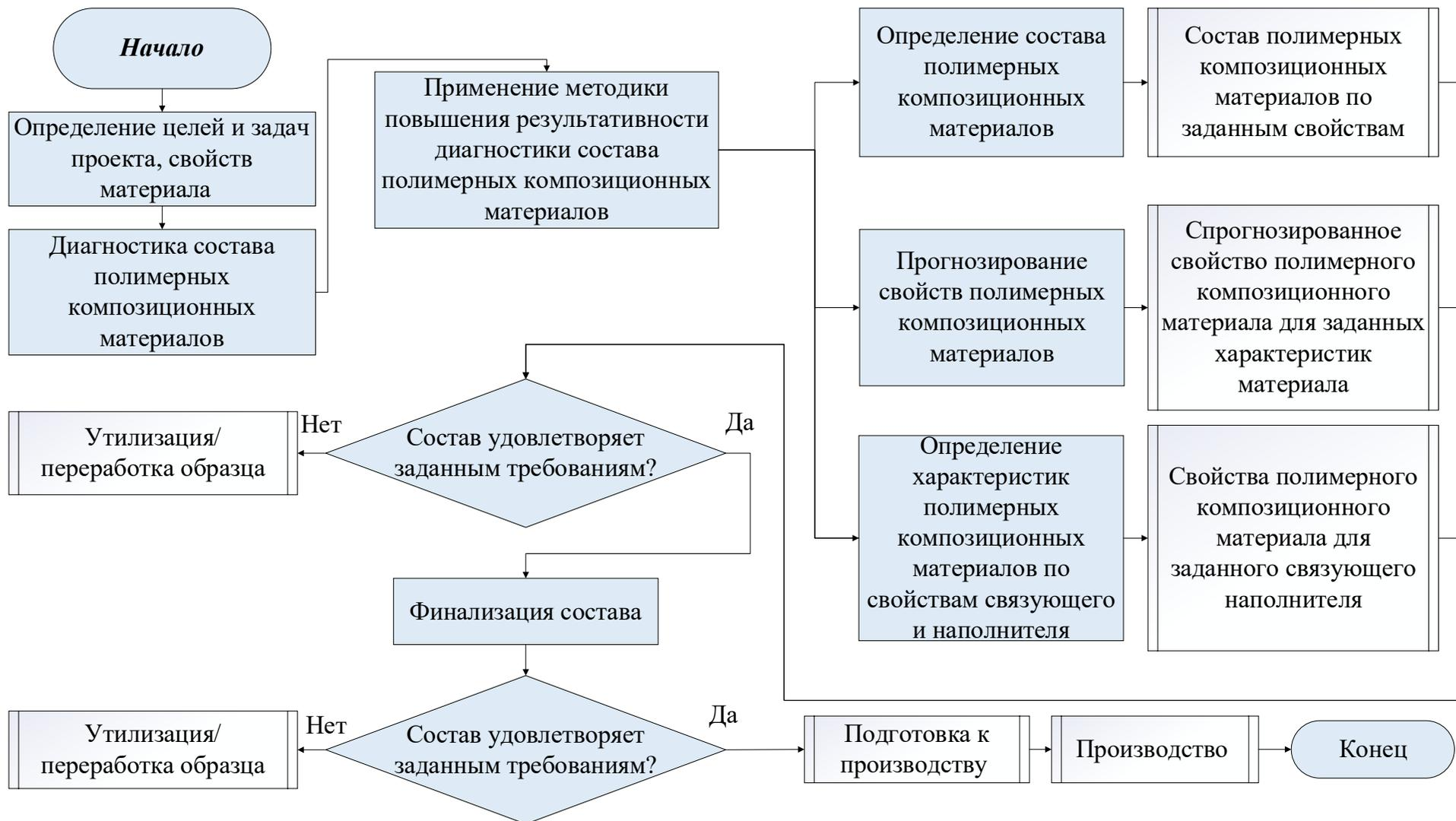
Рисунок 23- Методика диагностики состава полимерных композиционных материалов
