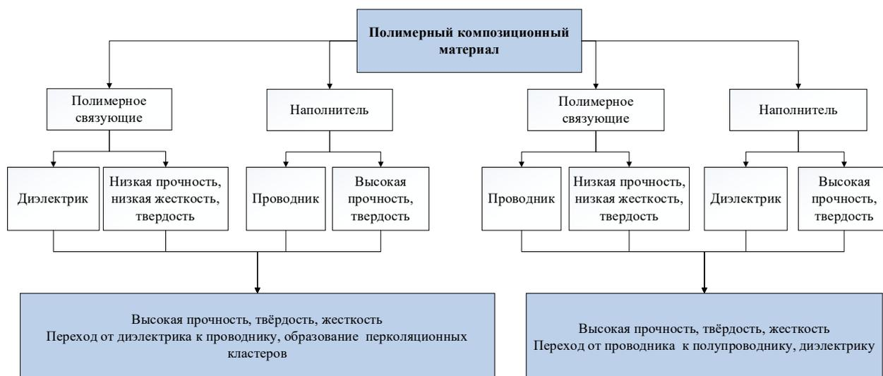
Рисунок 4- Влияние состава полимерного композиционного материала на свойства
