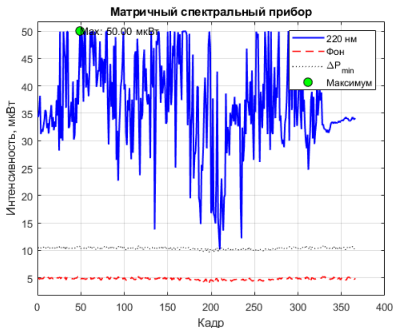
Рисунок 32 – Графическое представление распределения интенсивности сигнала по временным кадрам, полученное с использованием матричного спектрального прибора
