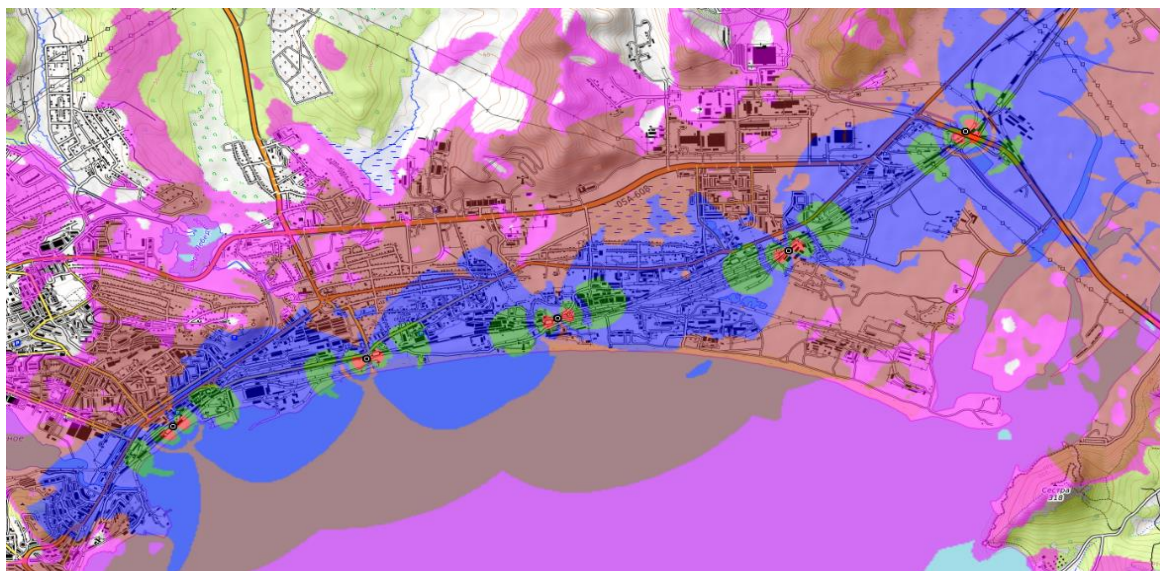
Рисунок 2.4.4 – Карта распределения доступных видов модуляции на линии вниз при учете внутрисистемных помех (зеленый цвет - 16 QAM, синий цвет - QPSK)
