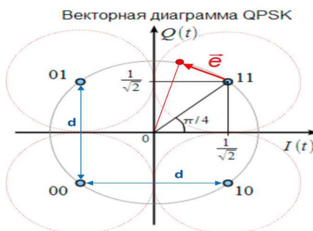
Рисунок 4.2.3 – Влияние эффекта Доплера на позицию точки сигнального созвездия «11» на векторной диаграмме модуляции QPSK (теоретическое) с указанием кодового расстояния d и предельных границ значений величины вектора ошибки (не более \frac{1}{\sqrt{2}} )
