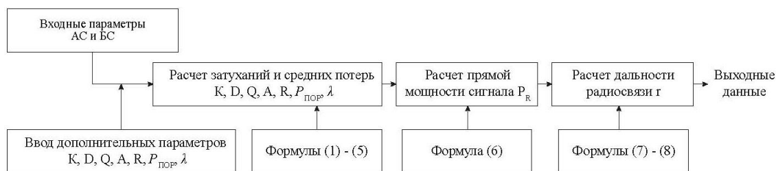
Рисунок 7 – Алгоритм расчета дальности радиосвязи БД №2025622894.
