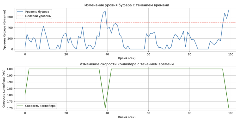
Рисунок 47 – моделирование работы РО буфера по предложенному алгоритму и математическому описанию системы розлива
