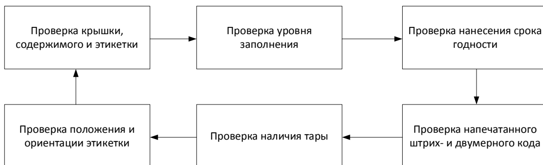
Рисунок 13 – Основные этапы контроля розлива бутилированной продукции системой технического зрения
