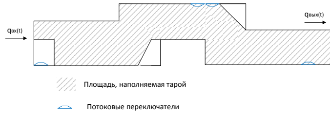
Рисунок 36 – Накопление в буфере, вызванное остановкой последующей ячейки ( q_{\text{вых}}(t) \leq 0 )
