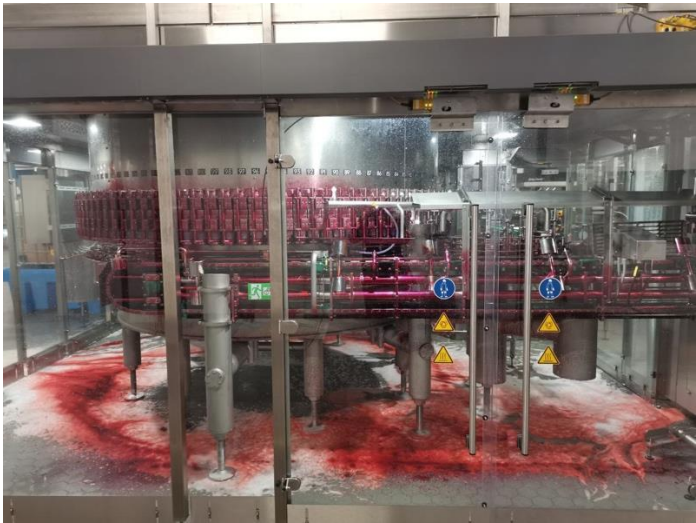
Рисунок 23 – Результаты процедуры контроля разбрызгивания материальных потоков упаковочной линии
