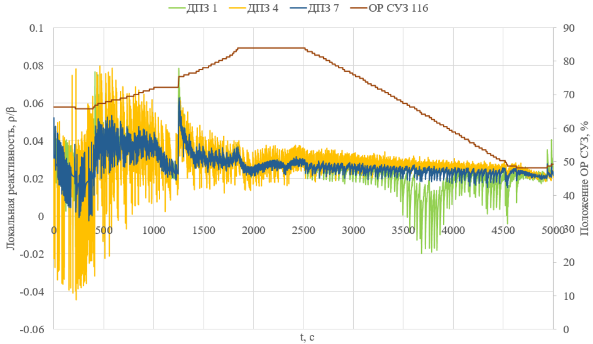
Рисунок 8 – Изменение локальных коэффициентов реактивности по показаниям ДПЗ и перемещения ОР СУЗ во времени в режиме 2
