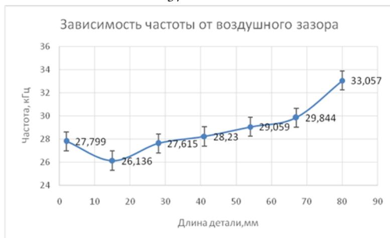
Рисунок 26 - Зависимость воздушного зазора от частоты при приближении датчика емкостного
