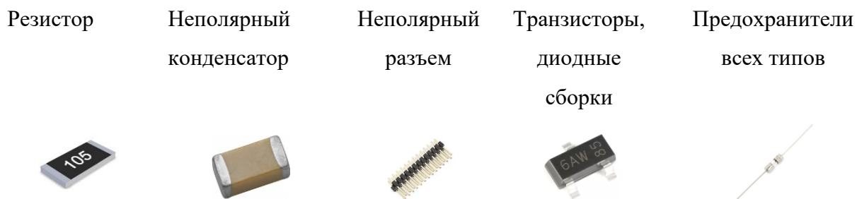
Рисунок 7 – Электронные компонентов, которые нельзя установить неправильно
