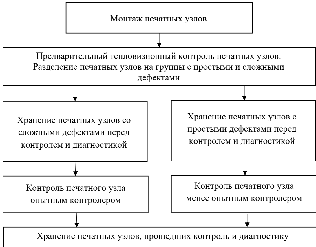
Рисунок 13 – Предлагаемое усовершенствование процесса контроля и диагностики печатных узлов
