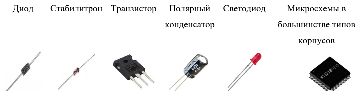
Рисунок 8 – Электронные компоненты, которые можно установить неправильно и это приведёт к неисправности печатного узла
