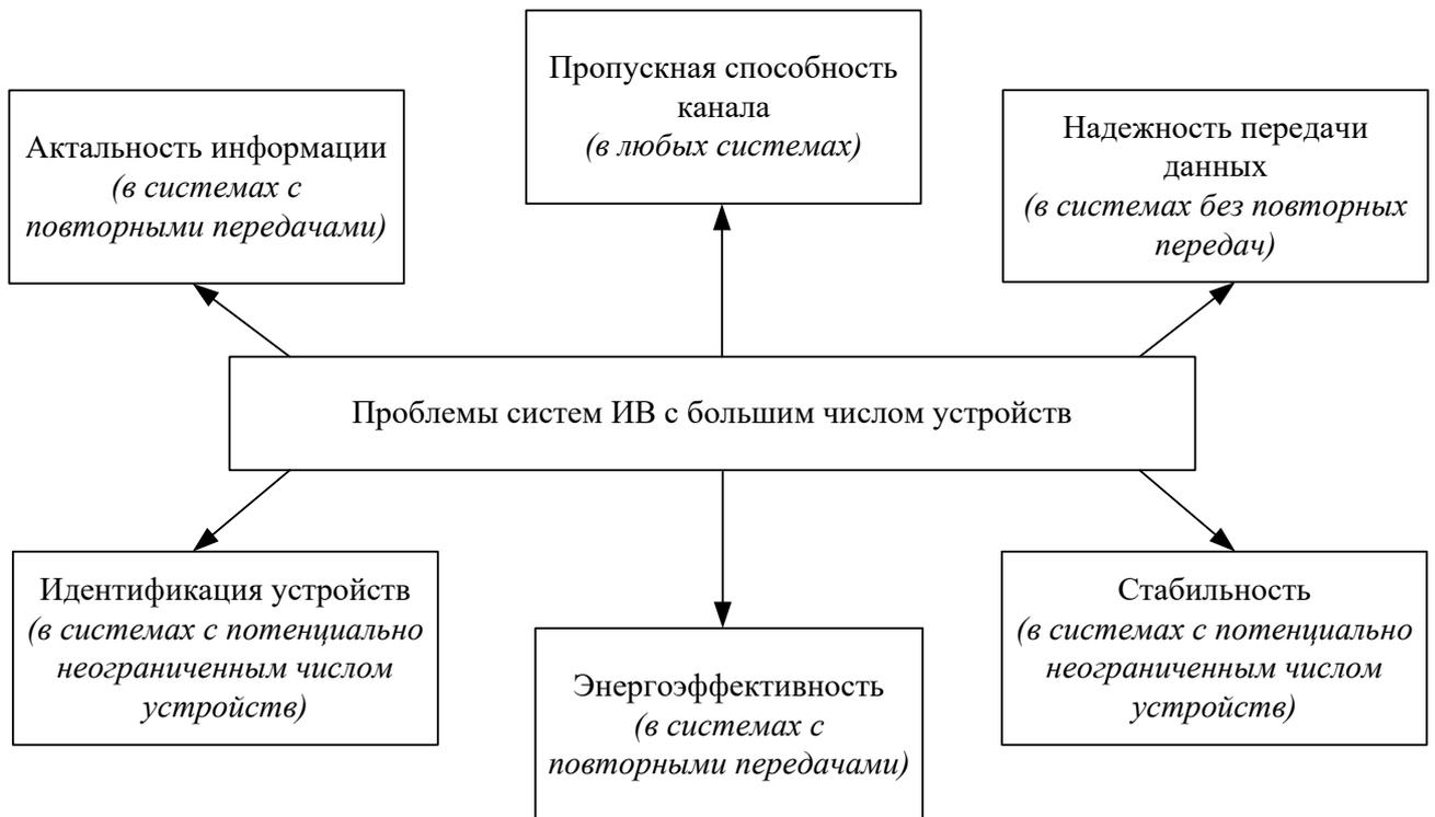
Рисунок 1.3 — Проблемы, возникающие в системах ИВ с большим числом устройств
