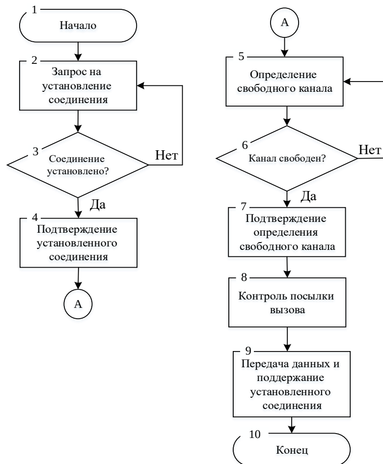
Рисунок 2.10 – Блок-схема этапов процесса передачи данных по беспроводным каналам связи
