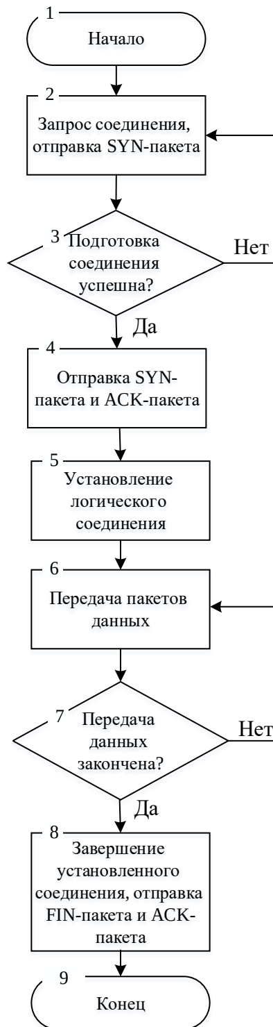
Рисунок 2.27. Блок-схема этапов процесса передачи данных по проводным каналам связи
