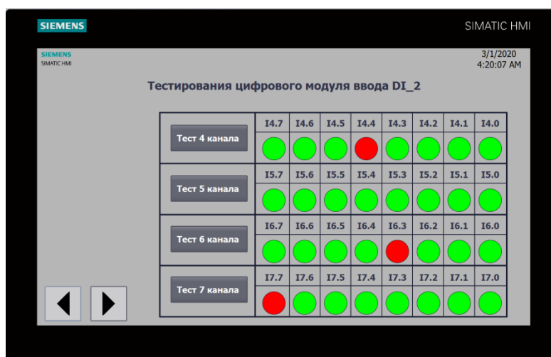
Рис. 13. Экран тестирования второго модуля цифровых входов DI_2
