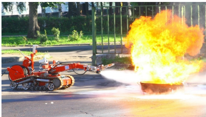
Рис. 4. Испытания робота МРК-РП при тушении пожара водой
