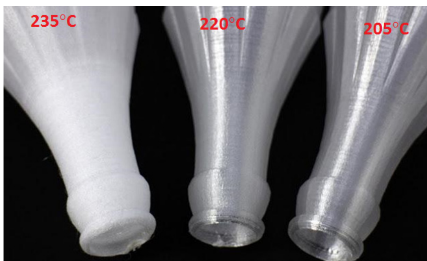
Рис. 11. Работа с полиэтилентерефталатом при разных температурах
