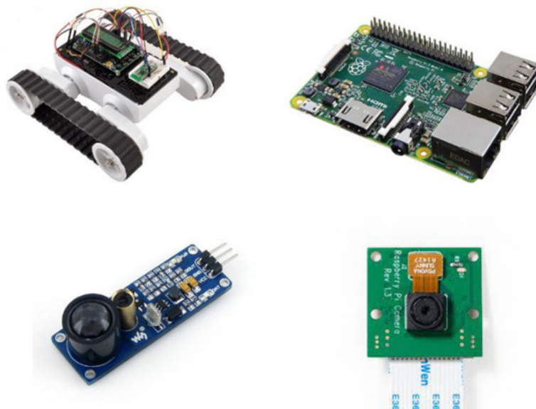
Рис. 2. Элементы системы навигации мобильным роботом на основе шасси Rover 5: Rover 5 Chassi; лазерный дальномер Камера Raspberry Pi 3
