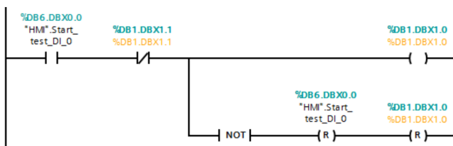
Рис. 15. Программный код для сброса бита состояния кнопки
