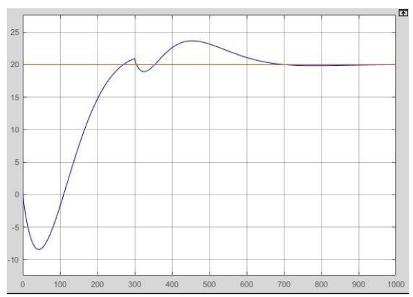
Рис. 3.7. Экранная форма графика уровня воды с ПИ-регулятором с возмущением
