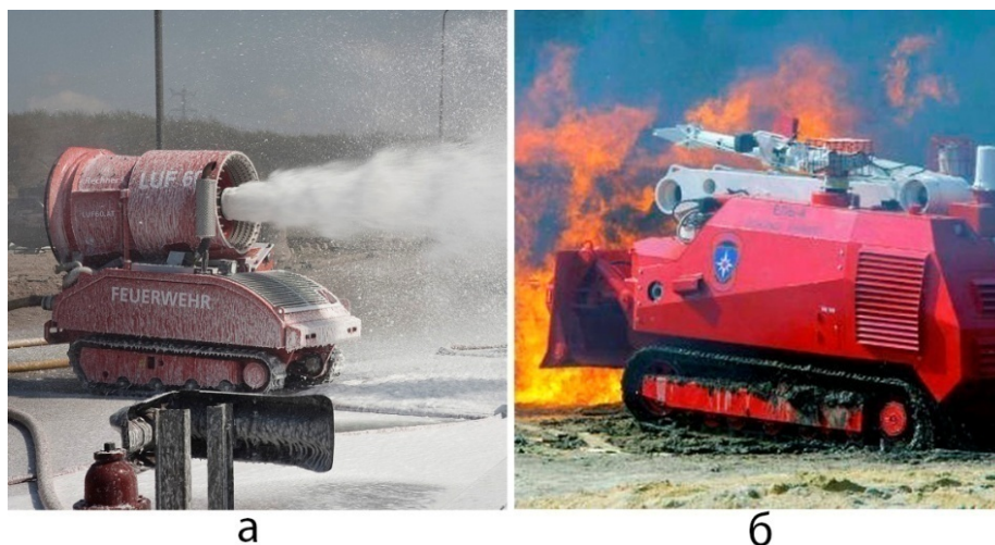
Рис 6: а – испытания РТС LUF 60 с использованием пожарной пены; б – тушение пожара на военном складе под г. Ачинск посредством РТС «Ель-4»
