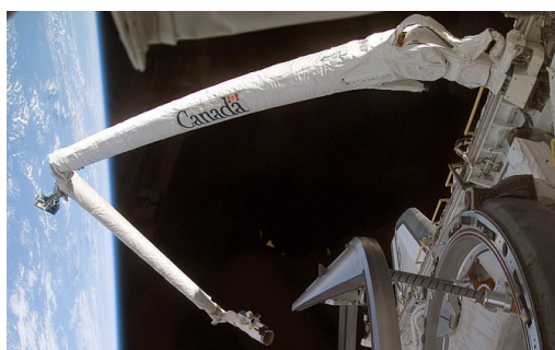
Рис. 2: а – внешний вид манипулятора «Canadarm-1»; б – астронавт Стивен Робинсон, удерживаемый системой «Canadarm-2»
