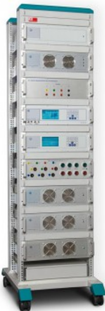
Рис. 1. Автоматизированная поверочная установка УППУ-МЭ 3.1КМ
