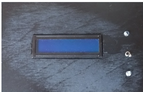
Рис. 3. Пульт для дистанционного считывания показаний и переключения режимов работы
