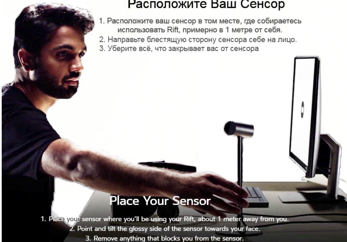
Рисунок 5. Пример правильной установки сенсора на стол.
