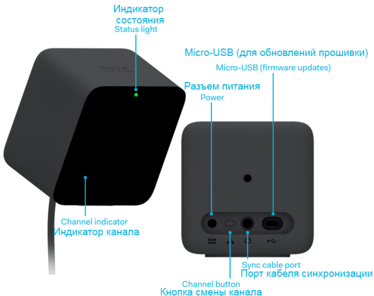
Рисунок 3. Основные элементы базовых станций.
