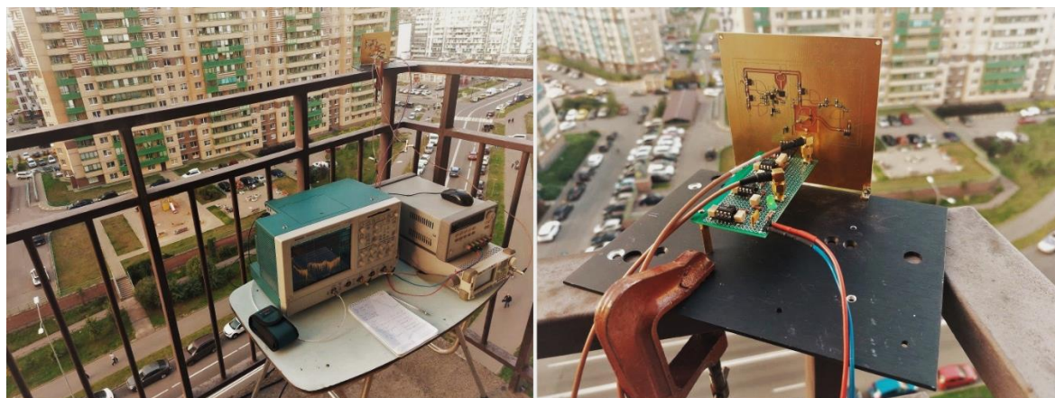
Рисунок 69 – Натурные испытания РВ с измерительным контуром ФАПЧ
