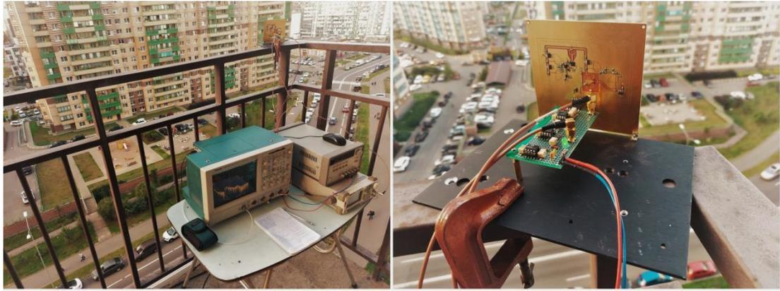
Рисунок 11 – Натурные испытания макетного образца РВ с контуром ФАПЧ
