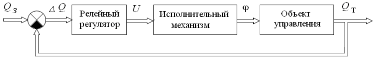
Рисунок 6.23 - Структурная схема релейной системы управления
