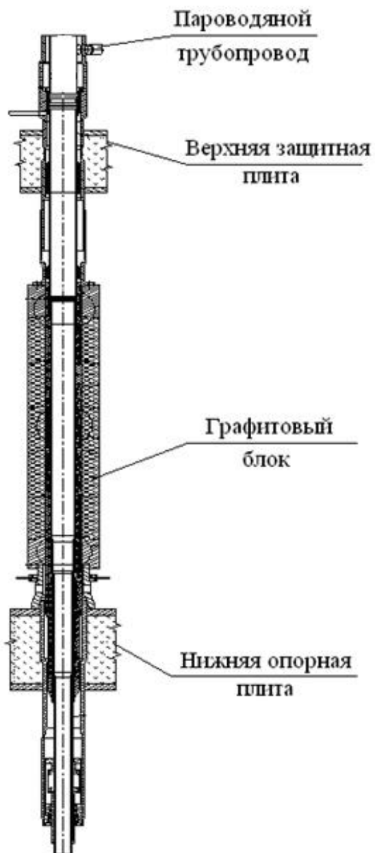
Рисунок 1.11 - Тепловыделяющая сборка (ТВС)
